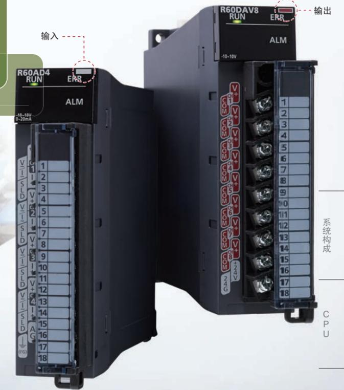
与输入输出模块相同，模拟量模块为传感器等各种模拟量软件与可编程控制器之间的接口。与输入输出模块的不同在于其处理模拟量电压和电流信号而非ON/OFF信号。MELSEC iQ-R系列的模拟量模块备有高速转换(80μs/CH)、高分辨率(1/32,000)及各种便捷功能，可进行高精度的模拟量控制。
