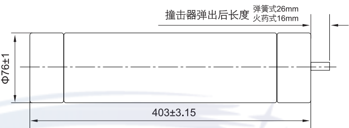
■XRNM1-7.2/224电动机保护用熔断件的外形尺寸 单位：mm
