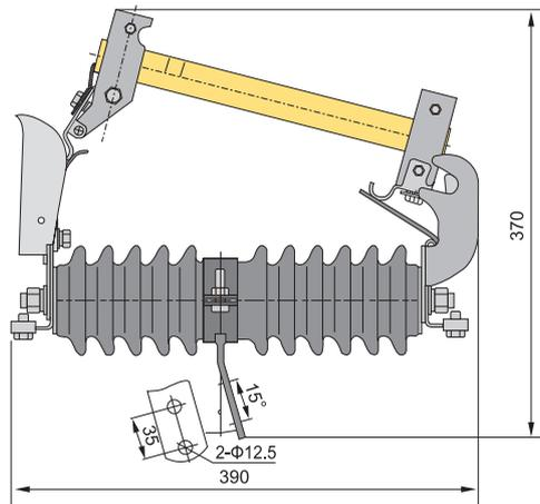
■ RW7-12户外交流高压跌落式熔断器的外形及安装尺寸
