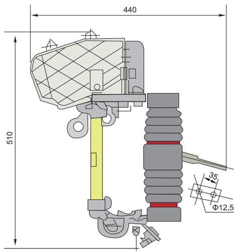
■ RW11-12户外交流高压跌落式熔断器的外形及安装尺寸
