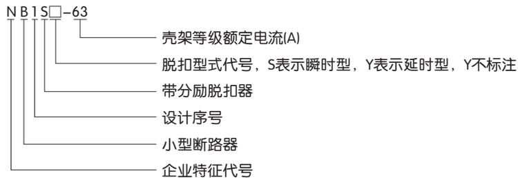
注:NB1S为控制信号断电延时脱扣, NB1SS为控制信号得电瞬时脱扣。
